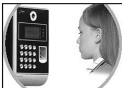
Рис. 4г. 4 УБ - считыватели карты, PIN кода, отпечатка пальца и лица
