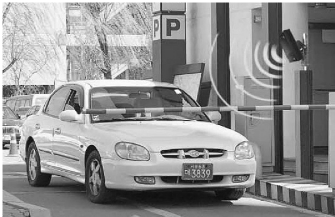
Рис. 5. Дистанционное считывание активной проксимити-карты
