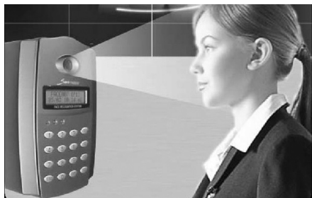
Рис. 3. Сканирование лица в считывателе-контроллере FACE 007
