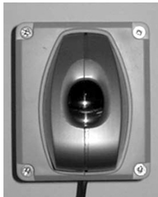
Сканер отпечатков пальцев. С креплением для монтажа на стене
